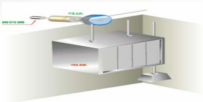
图33: 编码器、变频器在电梯中的应用模型
