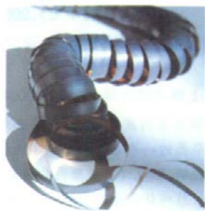
图 1 CuInS 2 柔性薄膜太阳能电池 Fig. 1 A flexible CuInS 2 solar cell
