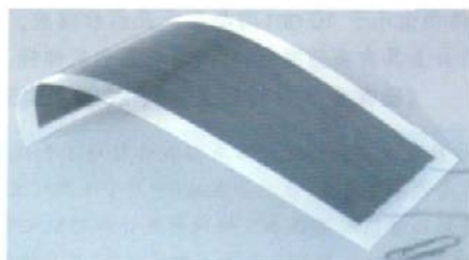
图 2 CuInS 2 柔性薄膜太阳能电池组件 Fig. 2 A flexible CuInS 2 solar module
