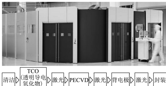
图 2 薄膜太阳能模块生产步骤
