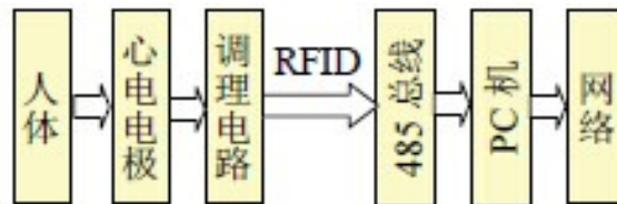
图 2 心电采集系统框图
