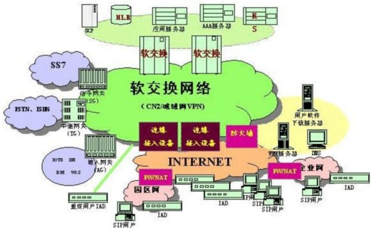
图1 软交换组网结构图
