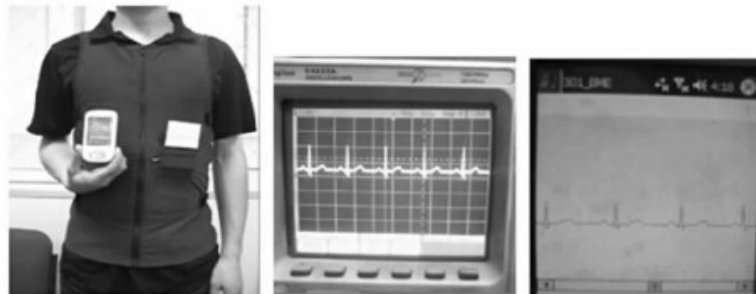
图 5 基于智能手机的穿戴式移动监测系统
