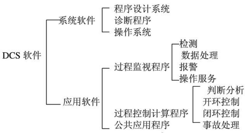
对 DCS 软件，在安装调试阶段主要是通过操作站的各项功能的检查、组态检查和系统回路调试来进行检查测试。调试程序按下列项目安排。
