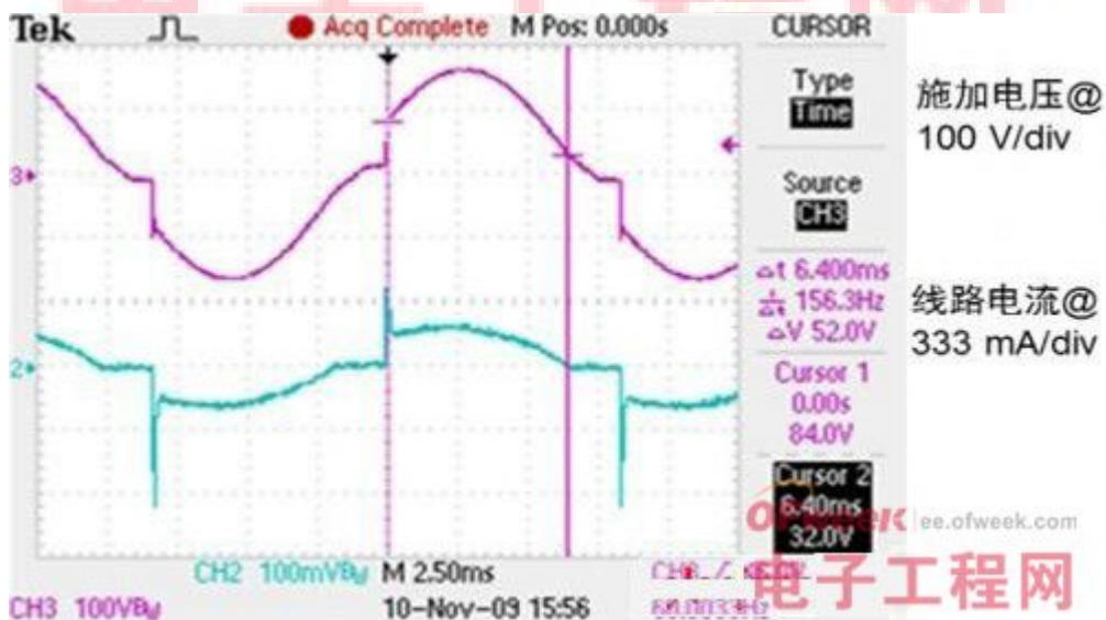
图 3 NCL30000 调光性能演示（通过改变调光器位置来在 350mA 至 1.7mA 之间调光）
