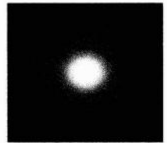
图2 归一化频率为1时的光纤中模场二维分布图
