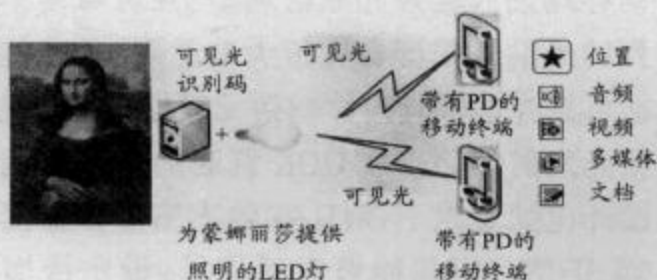
图 1 基于可见光通信技术的无线导航系统
