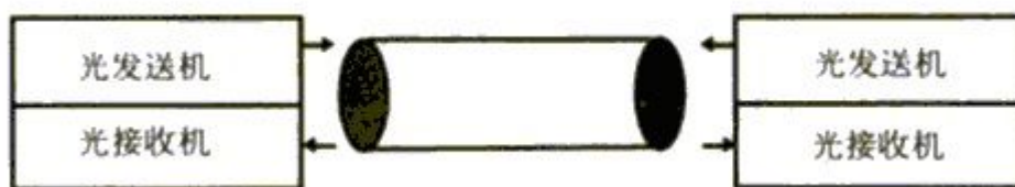
图 1-3-3 光纤通信系统的基本构成
