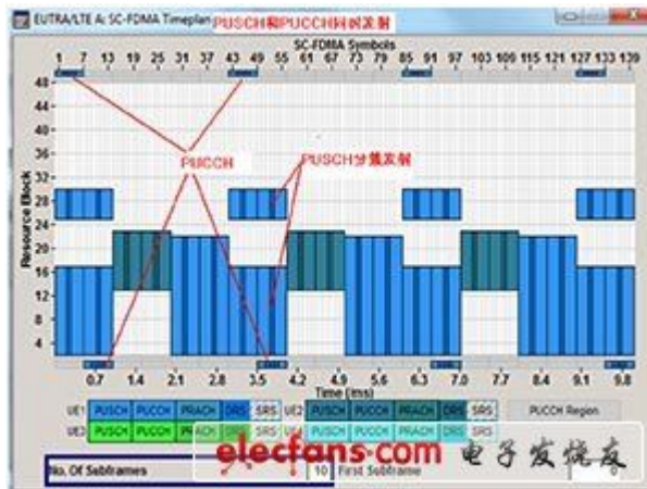
图5 利用 SMU200A 产生 LTE-A 上行信号
