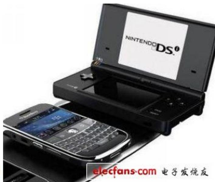
电磁感应解决方案在技术实现上并无太多神秘感，中国本土的比亚迪公司，早在2005年12月申请的非接触感应式充电器专利就使用了电磁感应技术。飞利浦最新推出的电动牙刷也使用了无线充电技术。而使用无线电波为数码产品充电的技术公司POWERCAST也已与飞利浦公司签署了合作协议，准备推出相关产品。而前文提到的麻省理工学院（MIT）物理教授Marin Soljacic带领的研究团队为其取名为WiTricity试验，由于使用的线圈直径达到50cm，还无法实现商用化，如果要缩小线圈尺寸，接收功率自然也会下降。他们预计在未来几年内，最终开发出能够安全为笔记本电脑和其它设备的无线充电产品。
