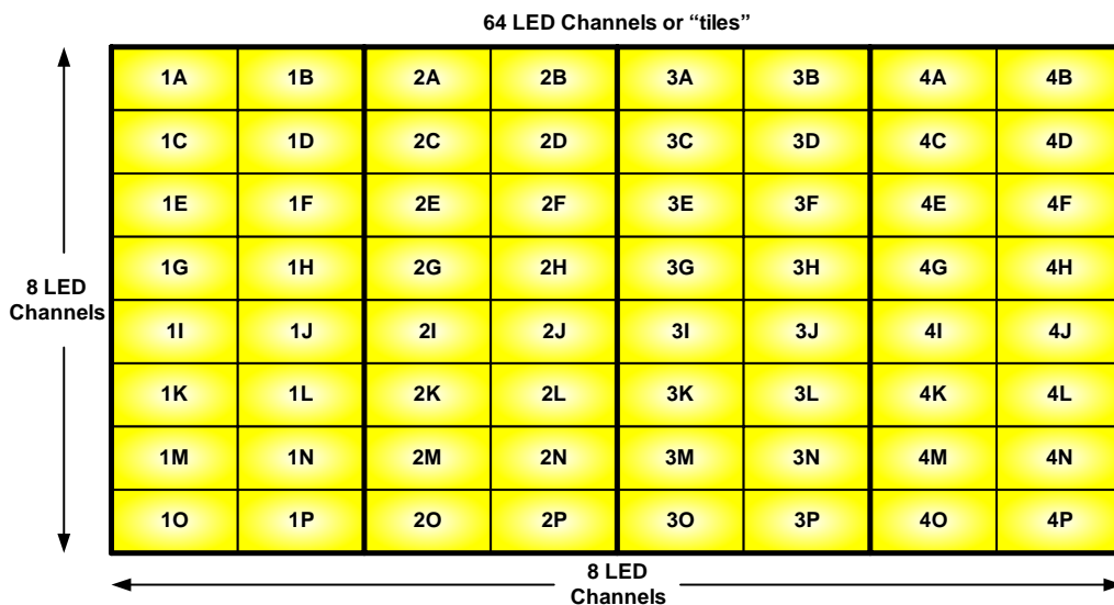
图 1：直下式背光液晶电视 LED 串排列成一组背光“模块”格
