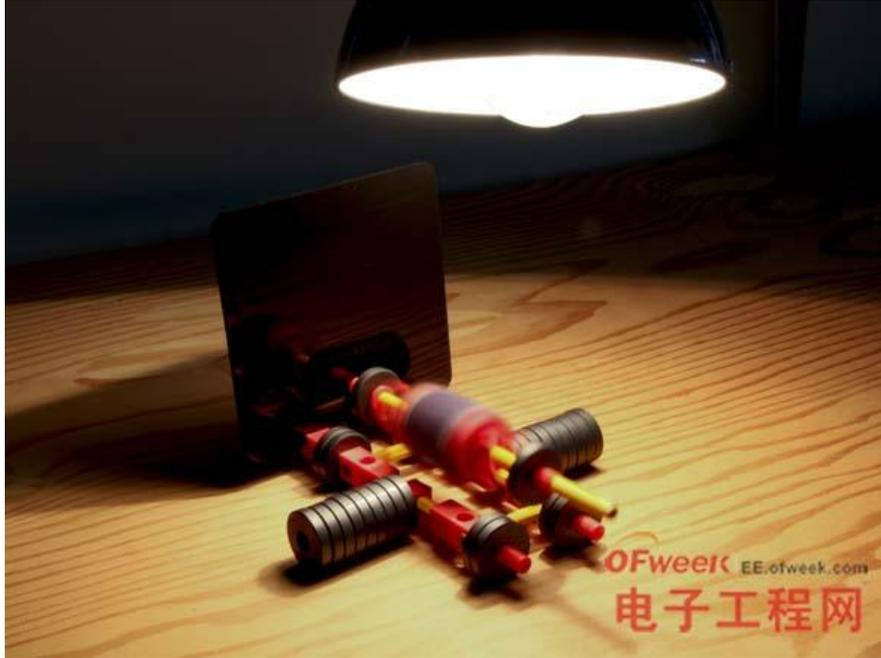
门多西诺电机（Mendocino Motor）漂浮在自己的磁场和光中，并将其转换成电和磁，并转动。
