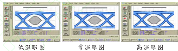
图 6 10 G 激光器发射光眼图
