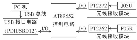
图2 主控制设备电路结构
