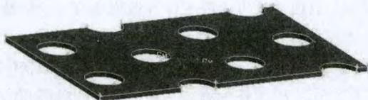
图4 铜翅片换热器三维立体图
