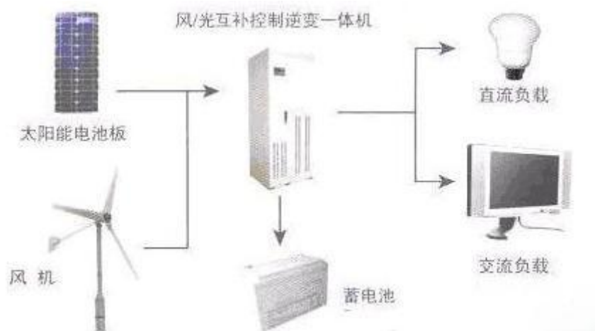
图 4 风光互补发电系统组成示意图
