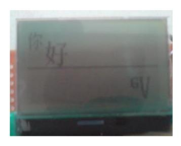
接下来贴上代码,由于每个厂家的 ST7565 的屏的接线都会有区别,所以这里就不给出写 ST7565 的实现,SPI\_Write()就是写 ST7565 函数,通过 LCD\_CMD/LCD\_CANVAS 来区分是写控制命令还是图像数据。这里的字模来自 Lcmz imo 字模工具。
