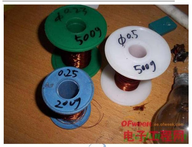
铜线的选择,据说线细电流小,线粗就电流大,不知道是不是这样。 而我用的是 0.5mm 的 QZ-2 漆包线
