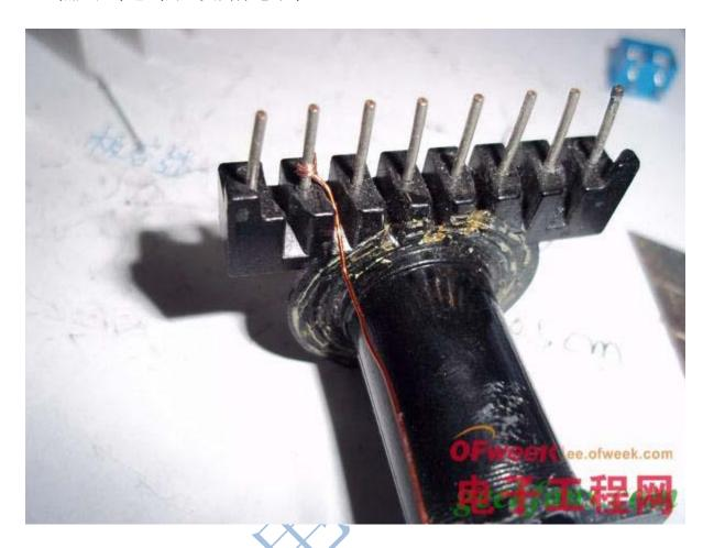
然后把刮掉漆的漆包线卷在引脚上,然后用焊锡焊接好。
