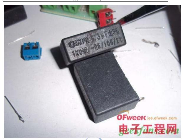
然后准备好两个 1200V 0.3µ 的电磁炉电容。
