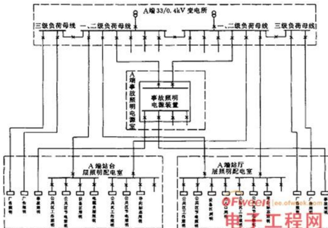
图1 地铁照明配电系统图
