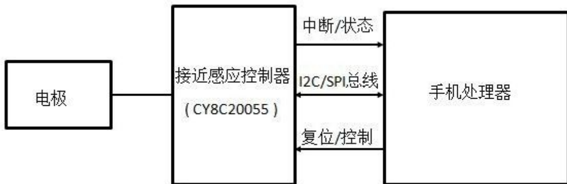
图1 电容式接近传感器的系统结构
