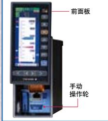
控制回路中设有独立的手动超驰, 以确保即使包含 CPU 的控制回路发生故障, 仍可继续控制。
