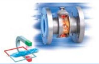
电磁流量计根据法拉第定律测量流量。线圈中励磁电流的频率影响测量精度和响应时间。
