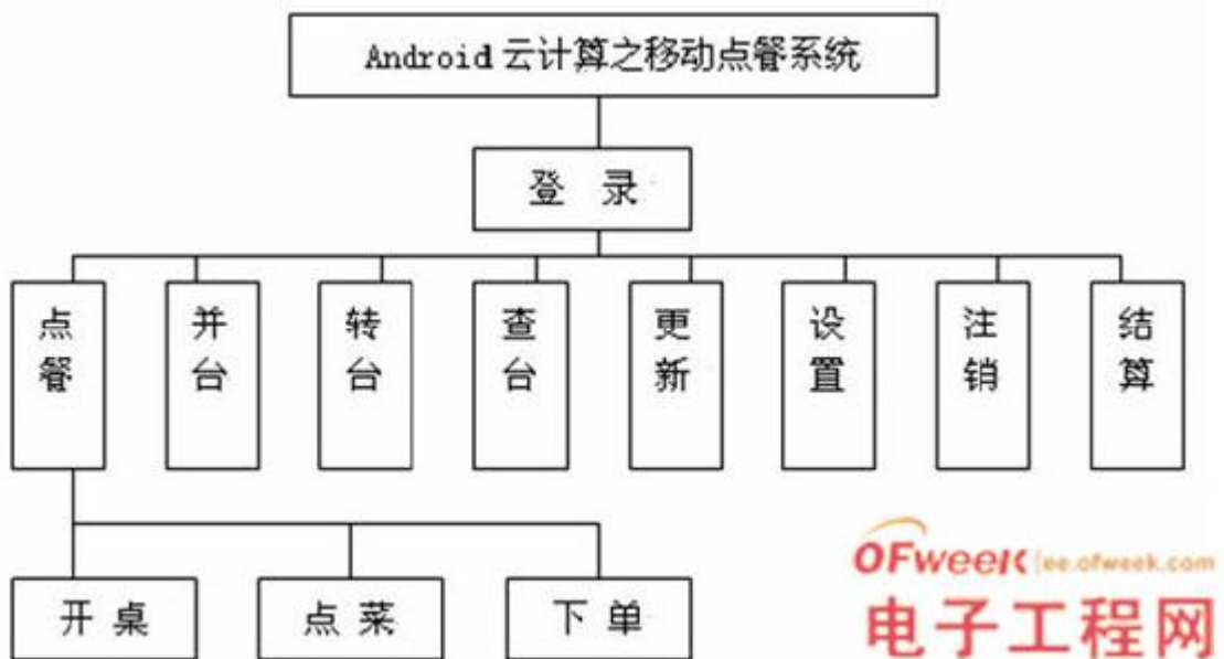
图4 系统功能实现框图。
