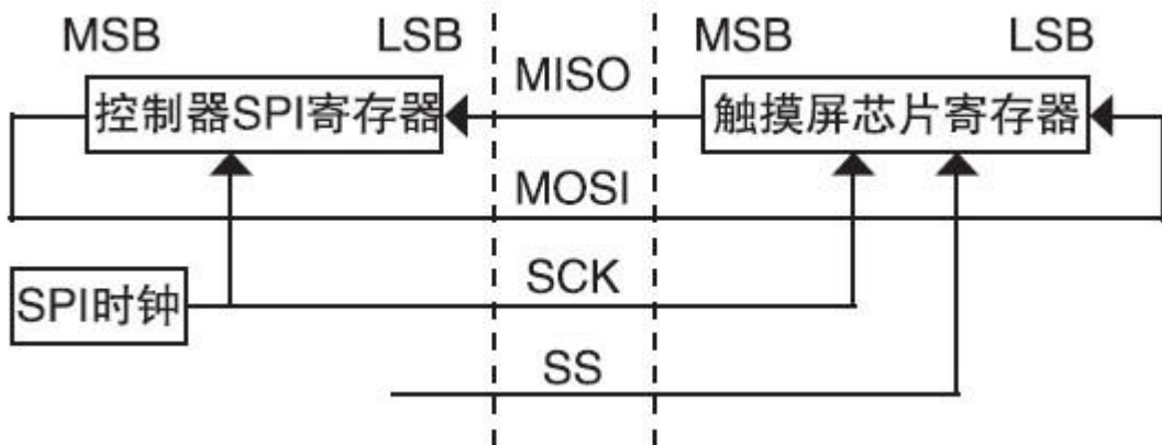
图 8 控制器 SPI 通讯框图
