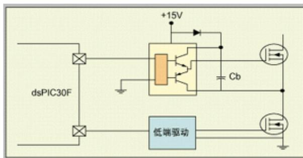
由于低端器件的电位是相对于电路的接地点而言的，因此在电源级电路中产生一个用于低端器件的栅极电源电压十分容易。栅极控制电压必须以源极电压为参考，在高端晶体管中它是满幅电压。因此，电源级电路中的高端器件需要一个栅极电源，该电源基于源极电压上下浮动。
