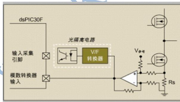
测量相电流的第三个方法是，在电源级电路的每个低端晶体管源极串联一只感应电阻器（图 4），用差动放大器来放大电阻器两端的电压，然后送入 A/D 转换器的输入端。在使用这个方法时，A/D 转换器必须与控制晶体管的 PWM 信号同步。为了得到精确的电流信号，应当在电源输出级中的低端晶体管开通时进行测量。在使用分流电阻进行测量时，内建有 A/D 同步逻辑电路的控制器很有用。
