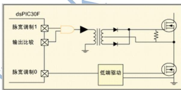
在许多马达控制设备中，线路总电源从与 AC 线路直接相连的全波整流电路获得并经过滤波。整流器的低端电压成为整个电路的参考电压 (0V)。不过，这一参考电压并非接地电压。在低端也存在交流电压，它在 0V 左右和峰值线电压间来回波动。在许多低成本应用中，将 MCU 或 DSC 基于这一低端电位上下浮动是有意义的。不过，如果设计要求测试或现场服务的话，出于安全考虑最好加上信号隔离。至少在产品开发阶段使用的马达驱动硬件应该具有信号隔离功能。
