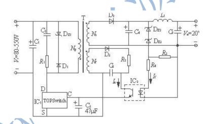
这是一个典型的单端反激式开关电源,大家再熟悉不过了,来分析一下一个工作周期,当开关管开通的时候,原边相当于一个电感,电感两端加上电压,其电流值不会突变,而线性的上升,有公式上升了的 I=Vs\*ton/L,这三项分别是原边输入电压,开关开通时间,和原边电感量. 在开关管关断的时候,原边电感放电,电感电流又会下降,同样要尊守上面的公式定律,此时有下降了的 I=V0R\*toff/L,这三项分别是原边感应电压,即放电电压,开关管关断时间,和电感量. 在经过一个周期后,原边电感电流的值会回到原来,不可能会变,所以,有 VS\*TON/L=VOR\*TOFF/L,,上升了的,等于下降了的,懂吗,好懂吧,上式中可以用 D 来代替 T O N,用 1 — D 来代替 T OOF,移项可得,D=VOR/(VOR+VS)。此即是最大占空比了。比如说我设计的这个,我选定感应电压为 80V,VS 为 90V,则 D=80/(\*80+90)=0.47
