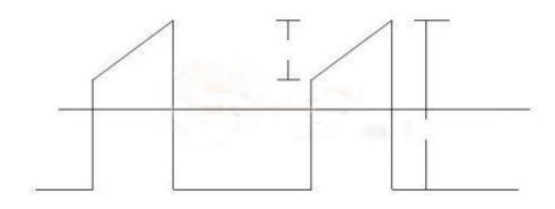
三个电流参数,就是这个电流的有效值,电流有效值和平均值是不一样的, 有效值的定义还记得吗,就是说把这个电流加在一个电阻上,若是其发热和另处 一个直流电流加在这个电阻上发热效果一样的话,那么这个电流的有效值就等于 这个直流的电流值。所以这个电流的有效值不等于其平均值,一般比其平均值要 大。而且同样的平均值,可以对应很多个有效值,若是把 KRP 的值选得越大,有 效值就会越大,有效值还和占空比 D 也有关系,总之。它这个电流波形的形状是 息息相关的。我就直接给出有效值的电流公式,这个公式要用积分才能推得出来, 我就不推了,只要大家区分开来有效值和平均值就可以了。
