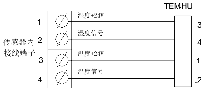
图5-10 温湿度传感器接线图
