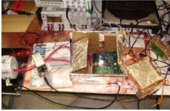
图 7，这个实验结构可向测量系统注入电流，以确保芯片可以承受大电流。覆箔的盒子隔离了外部的辐射，因此不会影响测量（Linear Technology 公司提供）。
