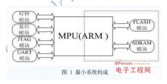
时钟模块——通常经 ARM 内部锁相环进行相应的倍频,以提供系统各模块运行所需的时钟频率输入
