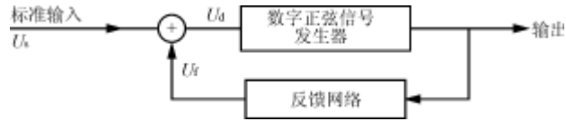
图 5 稳压反馈原理图
