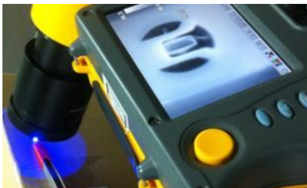
热像仪换装13.5μ m微距镜头在20mm处拍摄1.5mm 蓝光LED芯片现场图
