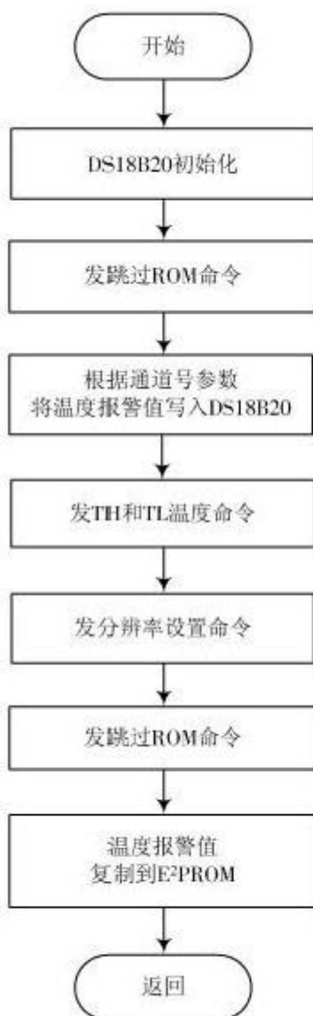
图4 设置温度报警值子程序流程
