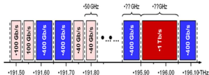
因此，从 100G 时代开始，传送的规则已经开始改变。从追求频谱效率的提升开始向追求系统总容量改变，Flex Grid 将成为速率提升的关键。此外，从香农定理可以看到，OSNR 成为另一个决定因素。基于软判决的 FEC 成为业界研究的主要方向，用以改善系统对噪声的容忍程度，以获得更长距离的传送性能。因此，软件算法也成了光领域的追逐对象。
