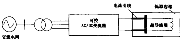
图3 SMES系统基本原理框图
