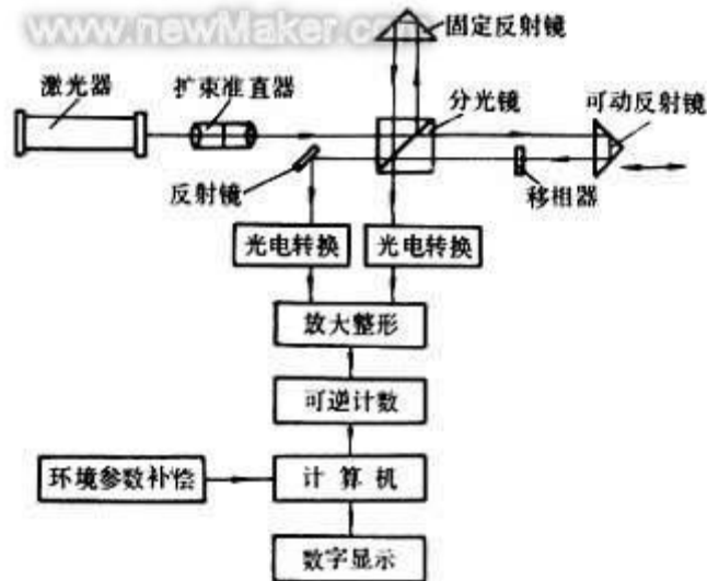
图1 单频激光干涉仪的工作原理
