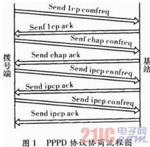
(3)接下来开始发起 lcp 通信，start\_link->lcp\_lowerup()，这个函数首先和内核的 PPP 协议进行协商，主要是 MTU 等链路参数，协商后设置 LCPDE-LAYED\_UP 标志，把 lcp\_delayed\_up 函数设置给一个定时器，这个定时器会根据 DELAYED\_UP 标志周期执行前赋给 lcp\_delayed\_up，在这里函数将主动发起 lcp 协议请求，之后等待对方回应。start\_link 函数结束返回到 pppd\_start() 主函数继续执行。
