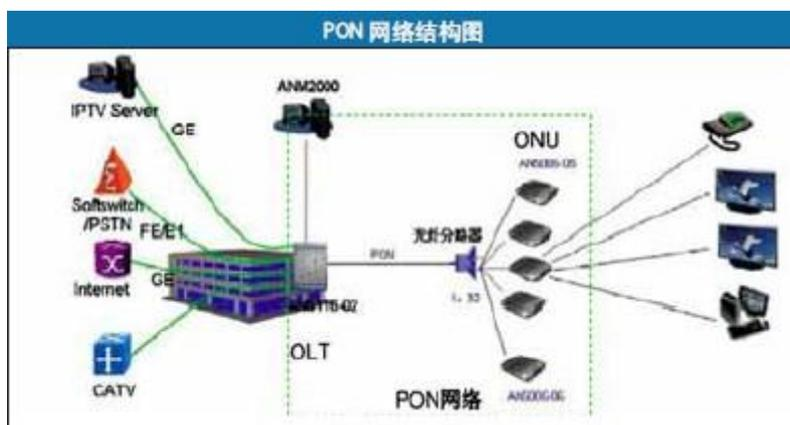
FTTx 语音业务如何部署：以电信集团为例，介绍 FTTx 语音业务的部署情况：电信集团根据用户性质不同，建议采用以下原则部署语音业务：1. 新建区的 FTTB/N/H 小区，一般不应再采用新建铜缆的方式提供传统的语音业务，而应采用 VoIP 方式提供语音业务；2. 对于 FTTB/N 小区，应采用 MDU 内置话音处理模块 (内置) 和独立式 IAD 的方式为用户提供语音业务；3. 对于实施 FTTH 的高端家庭客户，应通过 SFU 内置 IAD 或者家庭网关的内置 IAD 为用户提供话音业务；4. 对于已建 FTTB+LAN 小区的改造，宜保留现有 PSTN 网络的语音业务提供方式。
