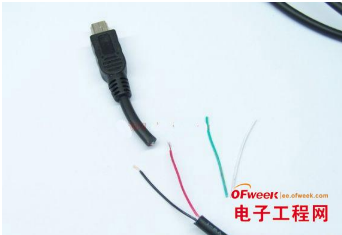
剪去 miniUSB 一端的接头 剪去 2 数据线 只留+5V 和 GND
