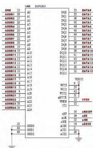
图 5 FLASH 存储器接口原理图
