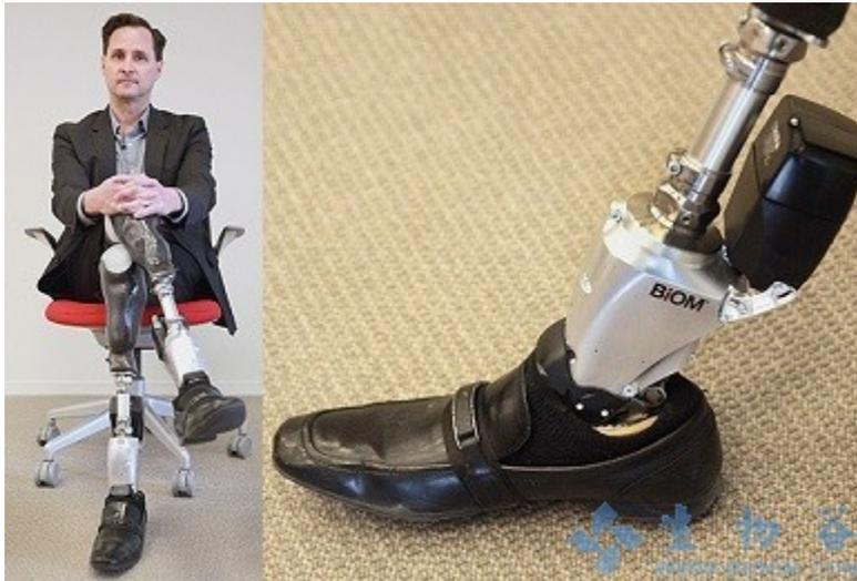
这 BiOMT2 电池供电的踝足假肢，由麻省理工学院的一位失去双腿的教授发明，能够模拟逼真的运动，并允许用户拥有更自然的步态。该器件结合了先进的电子和生物力学的功能，就像一个真正的脚和踝关节。
