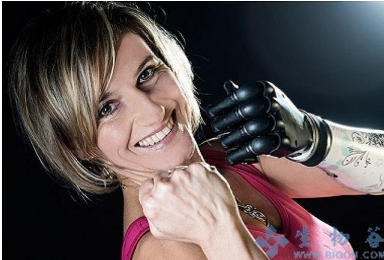
根据触摸仿生技术“i-limb™”的最新版本，患者假上肢现在可以设定多达 24 个命令到他们的智能手机，以帮助控制假肢的行动。通过肌电技术机器人附属物的工作原理：传感器检测微小的动作中的肌肉变化，在患者的假肢上的计算机将这些变化翻译称为数十个准确的动作。
