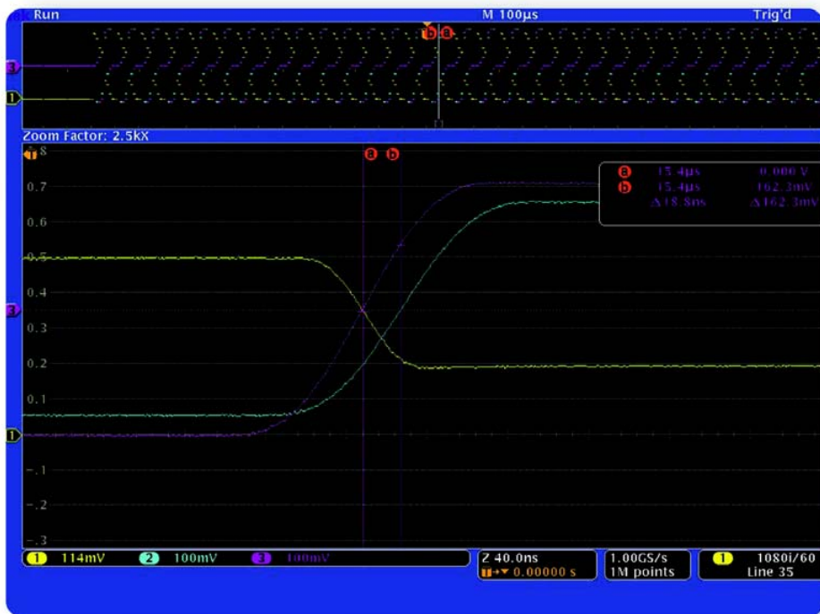
► 图 13b. 测量由于额外的电缆长度或延迟时间导致的 Pb 信号延迟。
