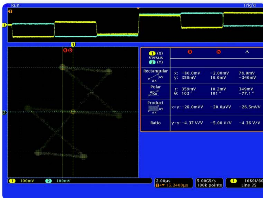
► 图 15. 4000 系列 XY 模式，用来查看与矢量显示器类似的显示画面。屏幕光标及极座标读数表明了红色矢量的幅度和相位。
