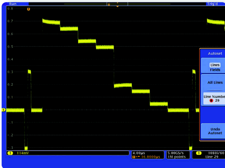
► 图 7. 通过 4000 系列的自动设置功能,用户只需按一个按钮,就可以设置示波器进行视频测量。
