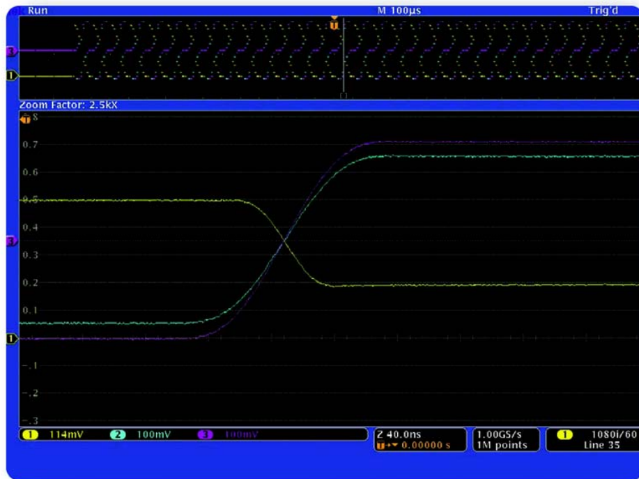
► 图 13a. 在 100% 色条信号从绿色跳变到洋红色的过程中，校正亮度(Y)和色差信号(Pb 和 Pr)的定时。
