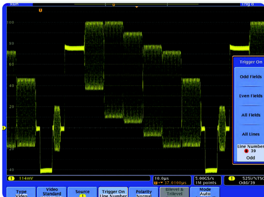
► 图 6. 4000 系列的视频触发功能可以方便地选择视频标准、来源、触发分量、极性和触发释抑设置。在本例中，示波器已经触发了 NTSC 信号奇数场的第 39 行。
