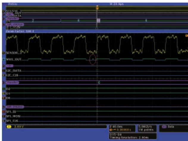
图 6. Wave Inspector® 揭示了 MUX_OUT 信号上的毛刺。
