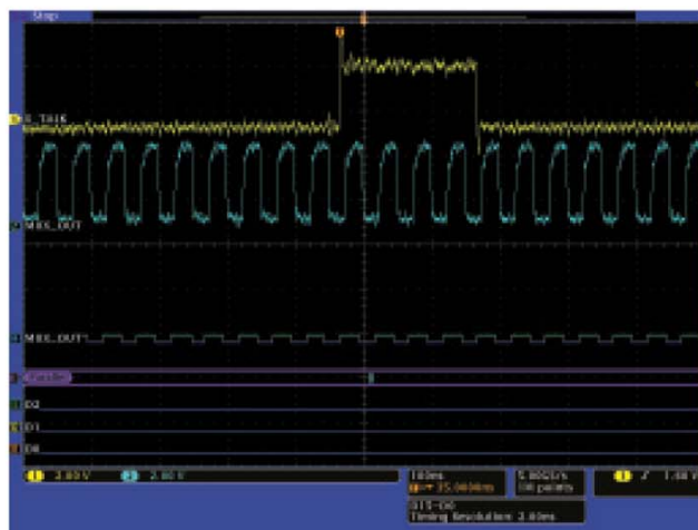
图 9. 在改动 PCB 后，串扰消失了。
