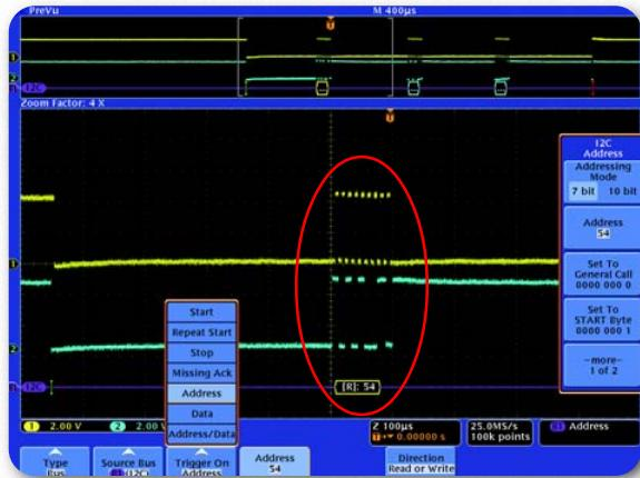
DPO4000 系列选装的DPO4EMBD 串行触发和分析功能可以迅速捕获和解码I<sup>2</sup>C 和SPI 串行总线业务，帮助检验和调试设计。
