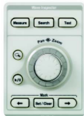
▶ 图6. Wave Inspector®可以有效查看、寻找和分析模拟波形数据和数字波形数据。
