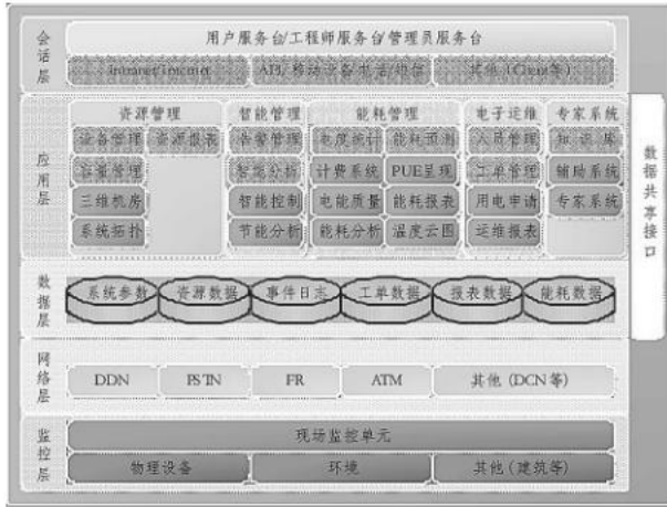
图2 某智能电网系统功能架构
