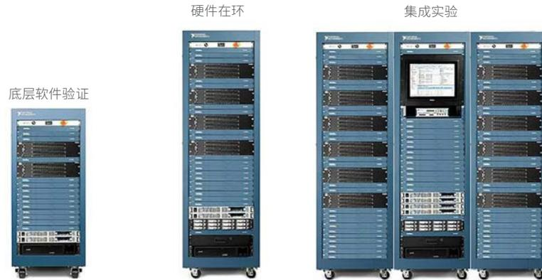
图6: NI HIL仿真仪使用COTS机架组件进行集成, 包括可编程电源、电源基础设施、HMI和19寸机架。
