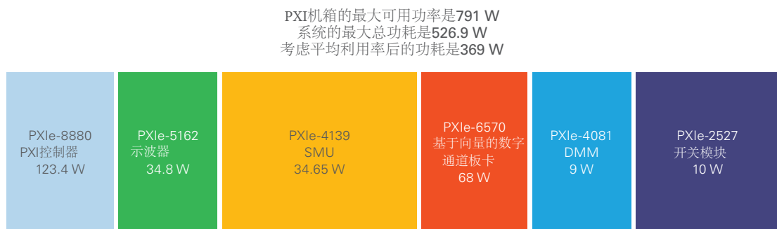
图6. PXI机箱的总功耗是机箱中所有模块的总和。可以看到在最坏情况下，机箱中的所有仪器将消耗526.9 W。
