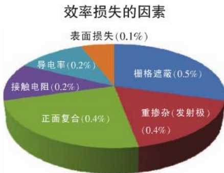
图 3 丝网印刷硅太阳能电池的损失因素
