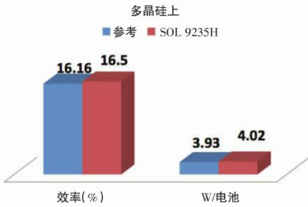
图 15 采用 SOL9235H 获得的电池性能
